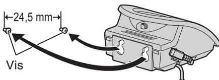
3 Montez le chargeur fermement sur les vis.
